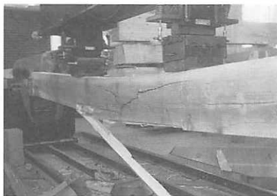
実大材の曲げ破壊試験
