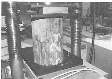
丸太の圧縮力測定（協力：長野県林業総合センター）
